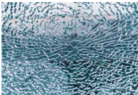
強化ガラスの破壊形状
